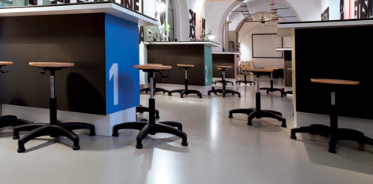
Гладкое полуматовое паропроницаемое бесшовное эпоксидное напольное покрытие. Толщина покрытия 2-4 мм.
