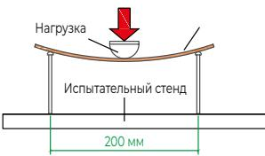
2. Измерение максимальной деформации
