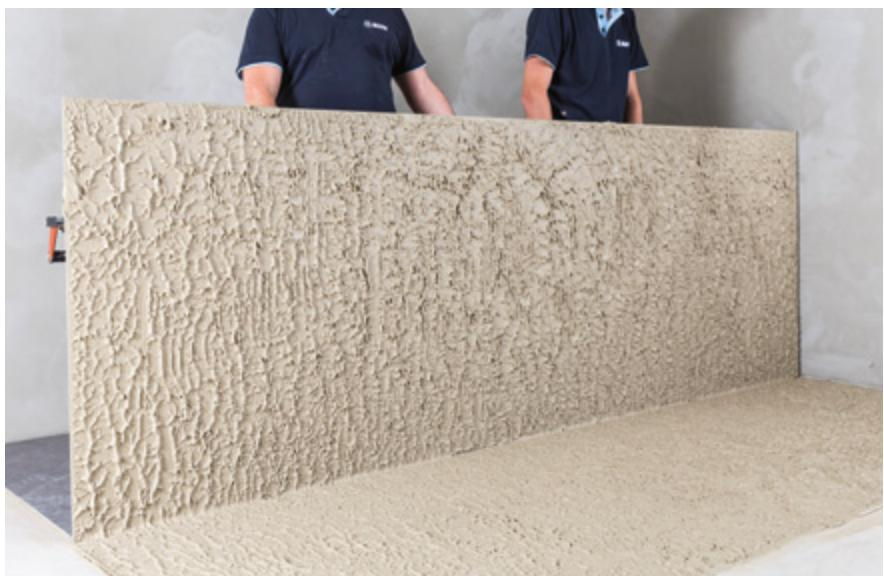
Выбор клея с хорошим смачиванием обратной стороны плитки
