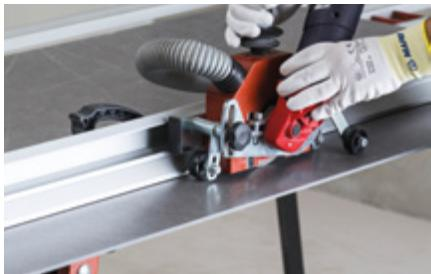
Прямолинейная резка с помощью УШМ
