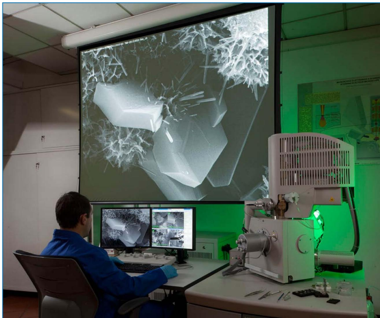
Электронный микроскоп ESEM-FEG
